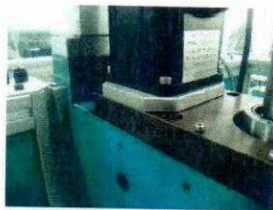
Gambar 12. Penambahan Flange Sebagai Dudukan Motor Baru
